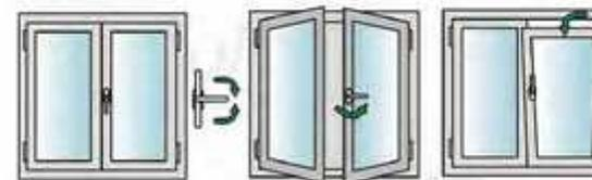
Ruotare la maniglia per apertura e chiusura. Per passare dall'apertura a battente alla ribalta (o viceversa) chiudere prima l'anta. L'apertura a ribalta permette l'aerazione evitando il rischio di chiusura a causa di colpi di vento. Chiudere e bloccare con i catenacci l'anta secondaria prima di chiudere l'anta principale.
