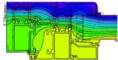
I calcoli sono stati effettuati nel rispetto della norma UNI EN ISO 10077-1 e UNI EN ISO 10077-2 e secondo la metodologia indicata nella linea Guida UNCSAAL UX10077
